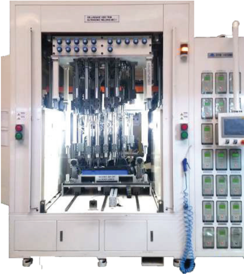
FARPLAS 42 UÇLU MULTI HEAD ULTRASONİK KAYNAK UYGULAMASI OTOMOTİV KAPI İÇİ PROJESİ
